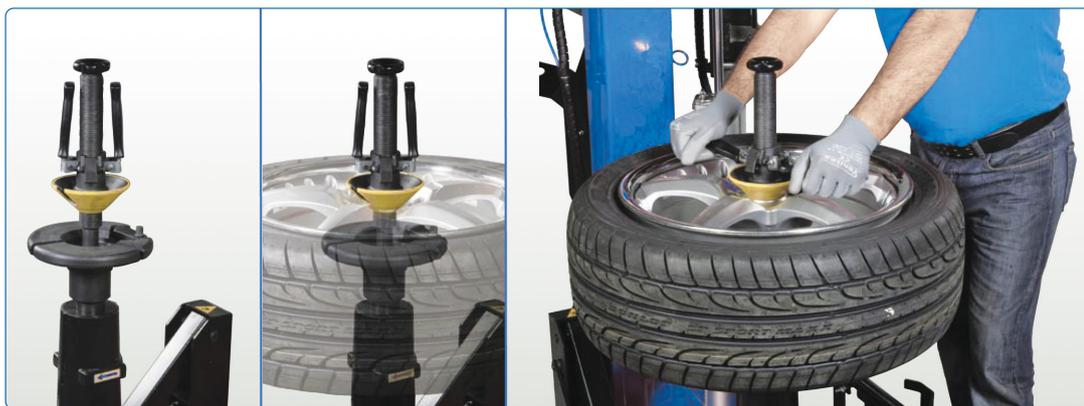
Осовой монтажный поворотный стол позволяет быстро и безопасно закрепить колесо и произвести отрыв кромки шины с обеих сторон. Не нужно переворачивать колесо (колесо закрепляется на станке лишь один раз)
