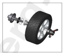
Хвостовик вала → пружина (встроена) → центрирующий конус (сужением наружу) → колесо → проставочное кольцо → быстросъёмная гайка.
