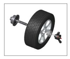
Хвостовик вала → колесо (установочная поверхность диска обращена внутрь) → конус (сужением внутрь) → быстросъёмная гайка.
