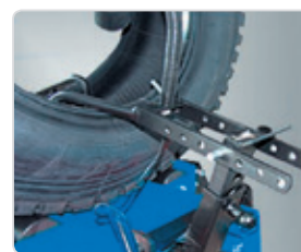
Настройка устройства расширения
