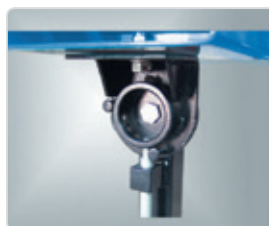
Регулировка наклона стола
