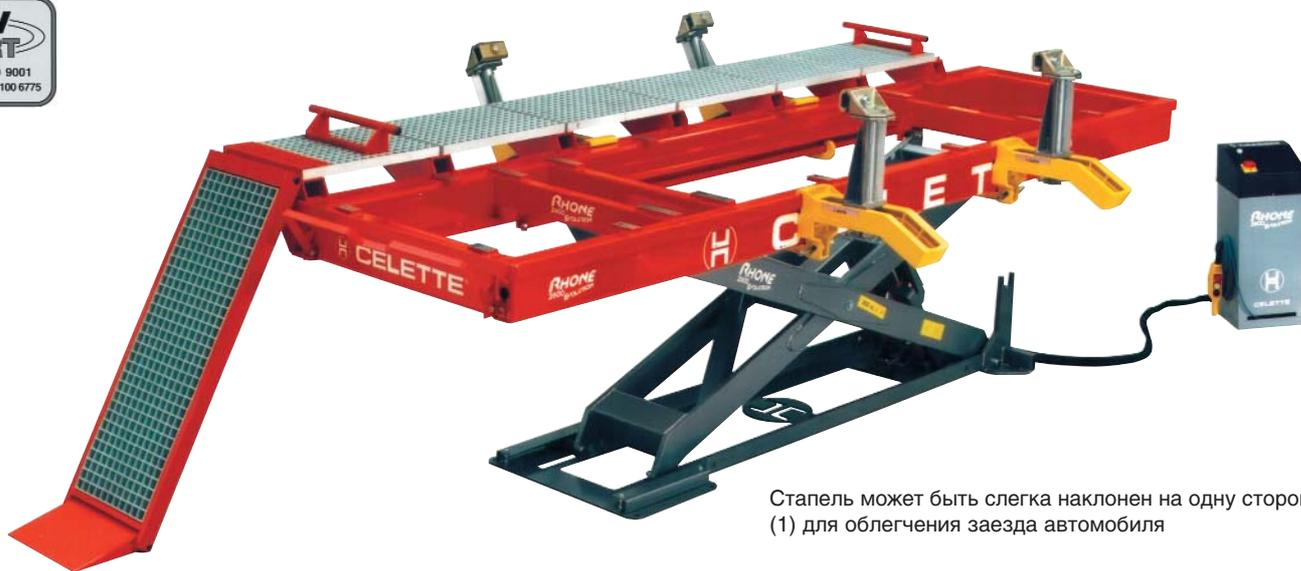
Стапель может быть слегка наклонен на одну сторону (1) для облегчения заезда автомобиля
