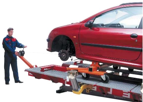
Включает ручную лебедку и тележку с зажимами для установки на стапель автомобиля без двигателя или без колес
