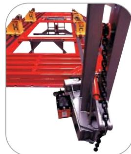
Благодаря скругленной платформе и направляющим роликам, силовая стойка может перемещаться по периметру стапеля в пределах 360°.
