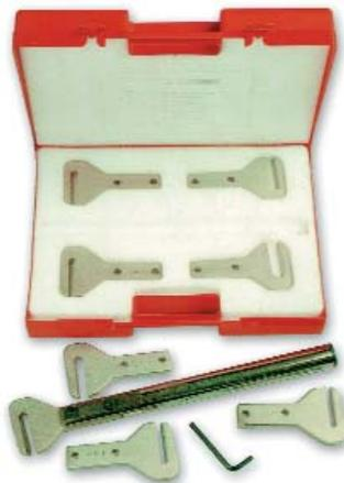
Наборы для регулировки приваренных петель, используемые для большинства автомобилей. Набор включает 4 или 8 сменных правосторонних головок и универсальный рычаг с байонетным замком. Головки крепятся к рычагу двумя винтами. Идеальная регулировка возможна даже при навешенных дверях, что облегчает и ускоряет работу на каждом этапе исправления геометрии кузова.
