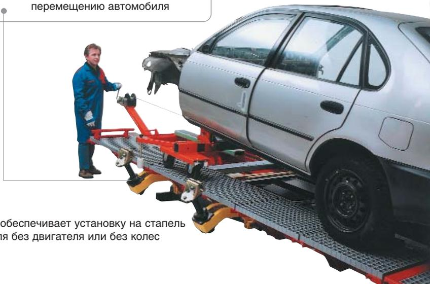
Комплект обеспечивает установку на стапель автомобиля без двигателя или без колес
