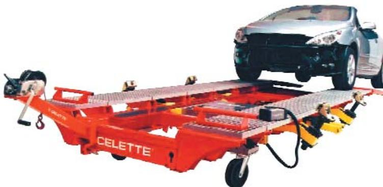
Комплект с ручной лебедкой и тележкой с зажимами обеспечивает установку на стапель автомобиля без двигателя или без колес
