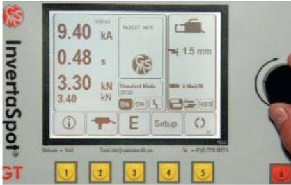
Экран отображения параметров сварки в Стандартном режиме
