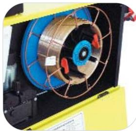
Возможна установка катушек с проволокой массой до 17 кг
