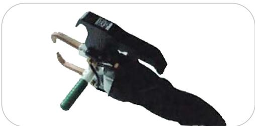
Х-обр. сварочные клещи со стандартными электродами длиной 110 мм
