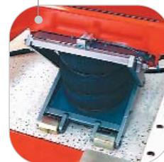
Пневматический домкрат для подъема/опускания стапеля
