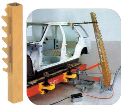
**Удлинитель для силового устройства Sevenne**
