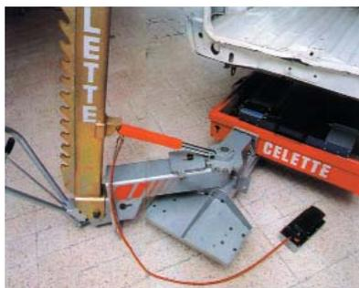
... поворачивается для создания усилия с разных направлений...
