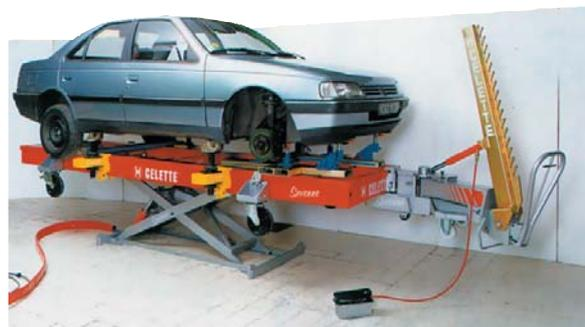
Стапель может устанавливаться на ножничный подъемник
