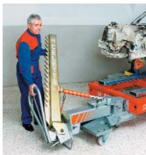
Стойка силового устройства наклоняется...
